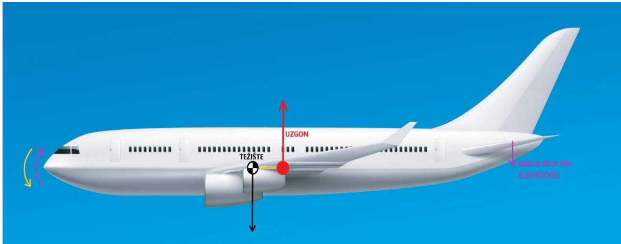
Slika 9. Težište pomaknuto prema zadnjoj granici Izvor [9]
