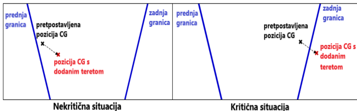
Slika 13. Nova pozicija težišta uslijed pozitivnog momenta
