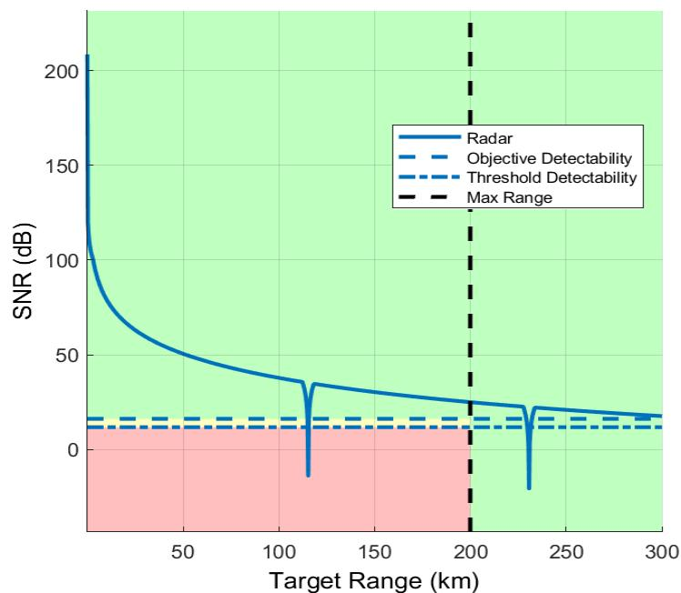
Slika 9 Prikaz omjera SNR-a i dometa iznad mora
