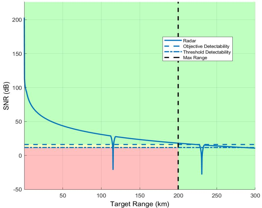
Slika 18 Odnos SNR-a i ciljanog dometa, osnovni parametri
