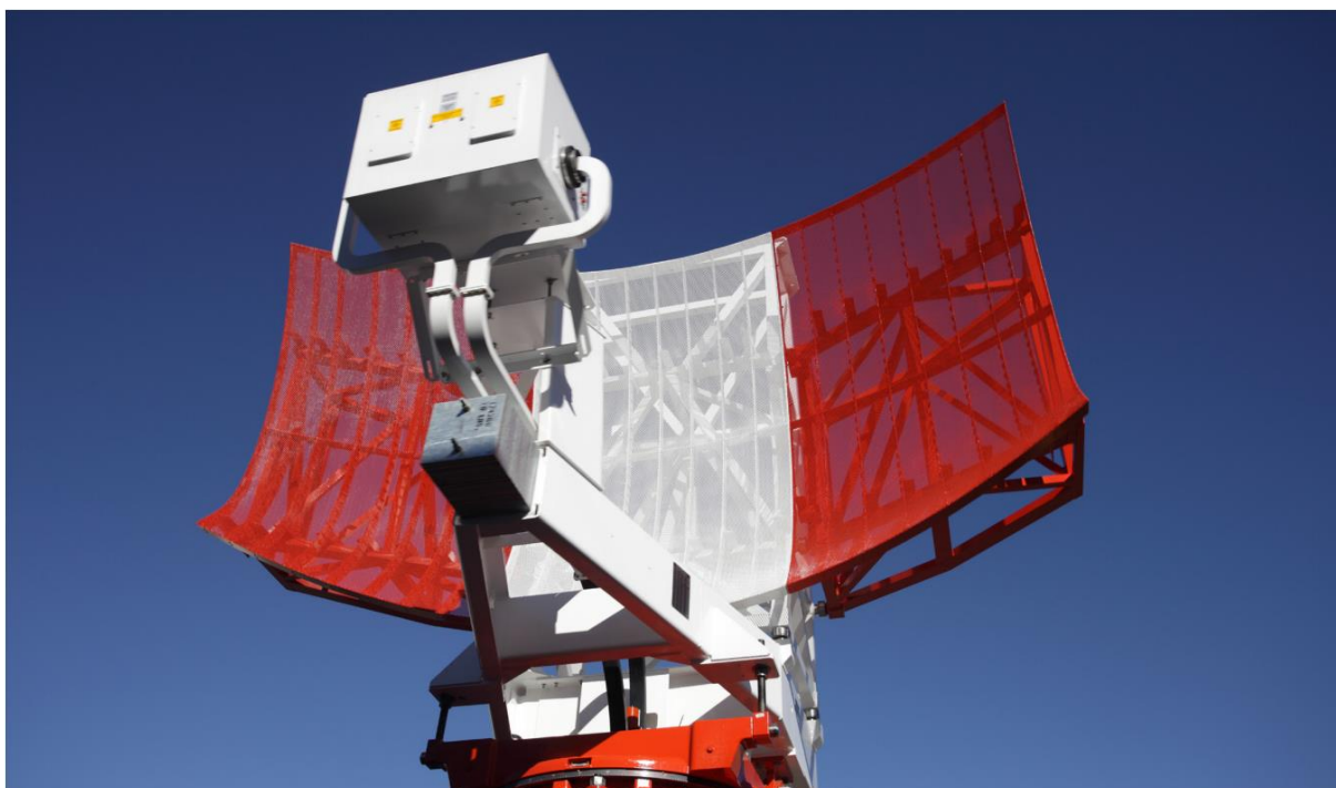
Slika 3 Standardni izgled primarnog radara
