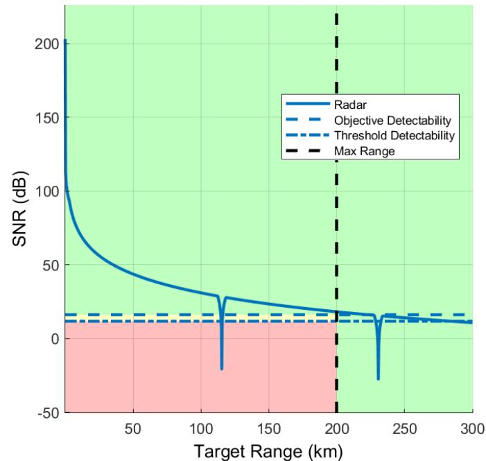
Slika 14 Omjer SNR-a i dometa kod gustog drveća
