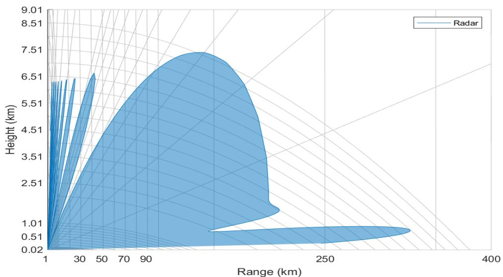
Slika 11 Vertikalna pokrivenost radara iznad pustinje
