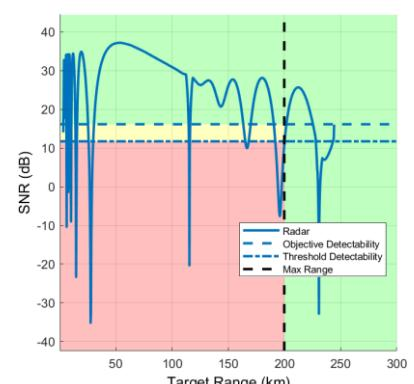
Slika 25 Omjer SNR-a i ciljanog dometa za zrakoplov na 3000 m
