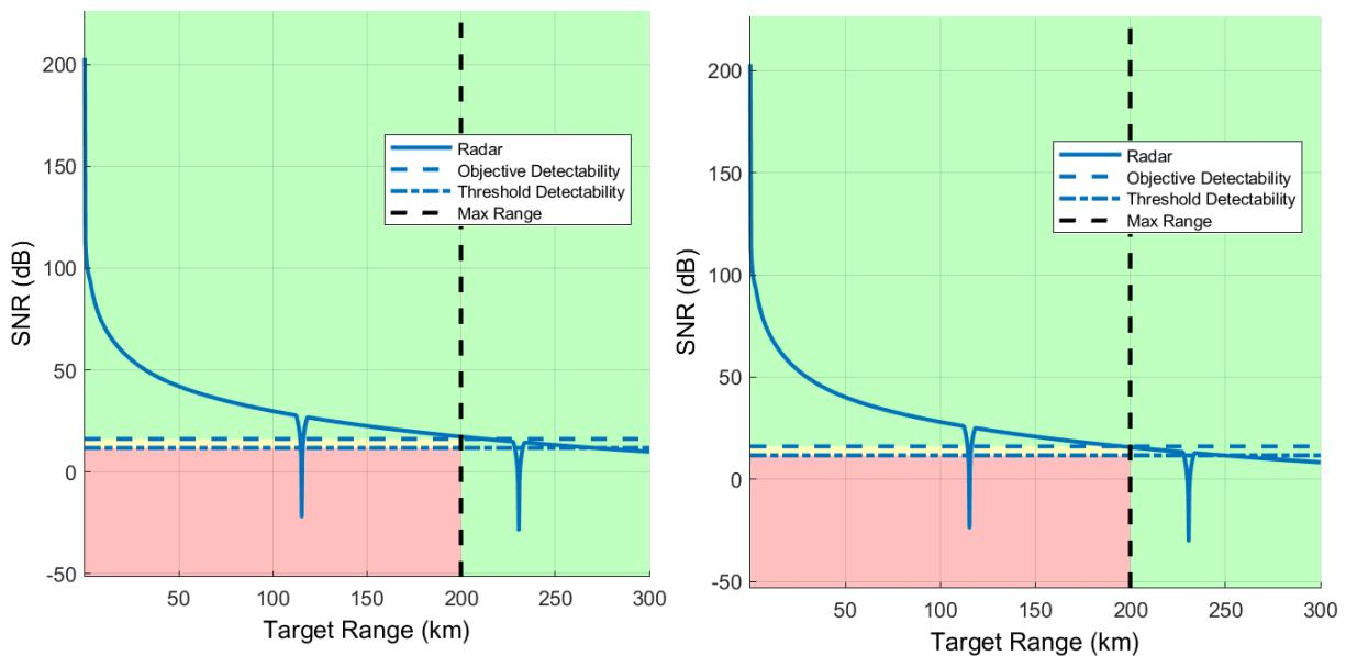
Slika 20 Omjer SNR-a i dometa kod kiše 50 mm/h
