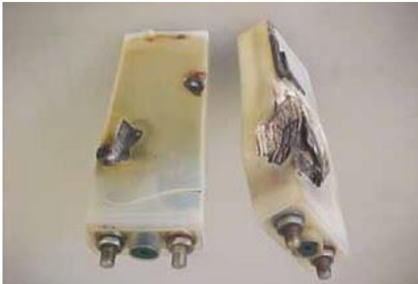
Slika 8. Nepovratna šteta učinjena termalnim bijegom, [12]
