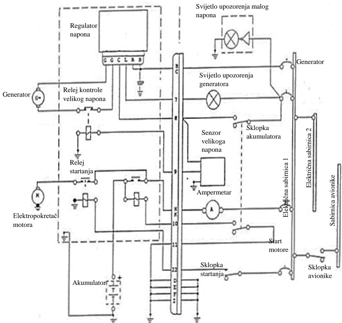
Slika 18. Električni sustav zrakoplova Diamond DV20, [10]
