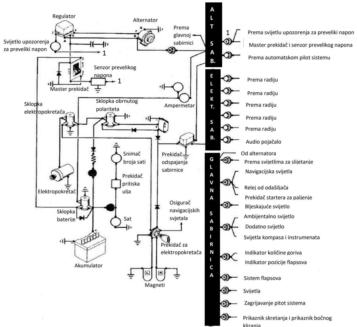
Slika 15. Shema električnog sustava zrakoplova *Cessna 172*, [9]
