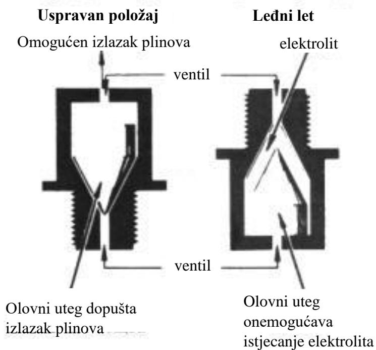
Slika 5. Princip rada čepa sa oduškom, [11]
