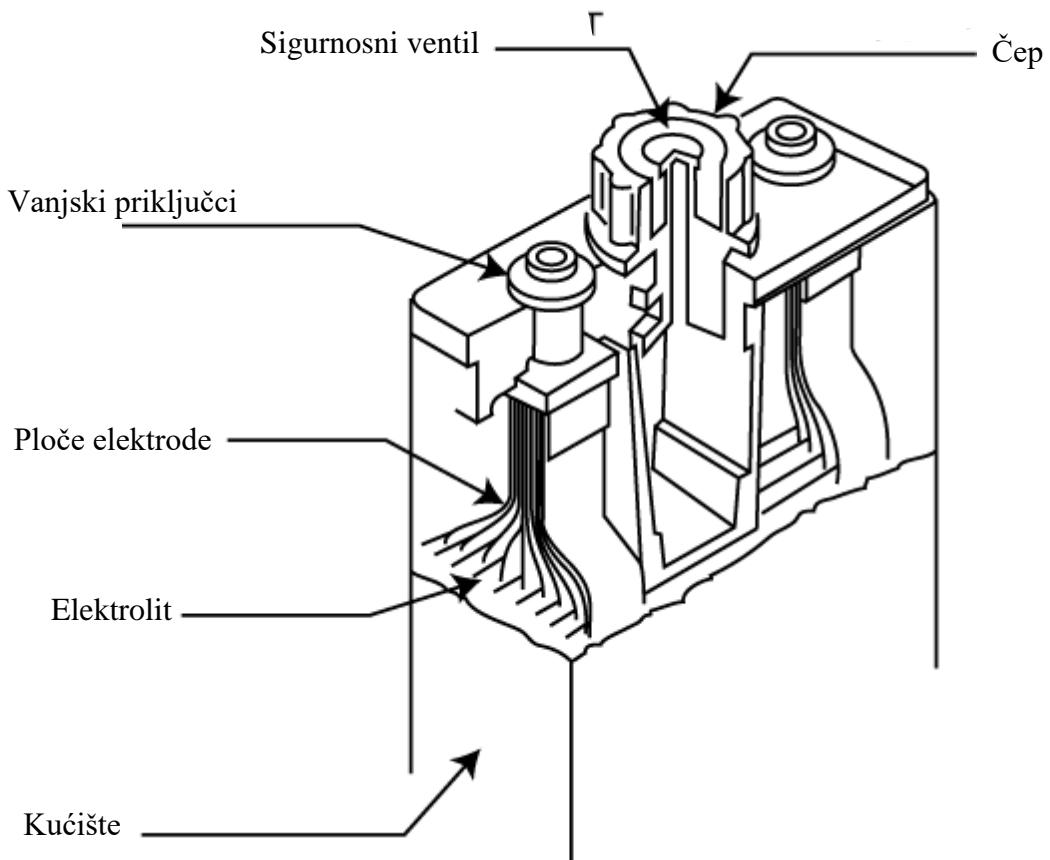
Slika 9. Uobičajena konstrukcijska izvedba Ni-Cd akumulatora, [13]
