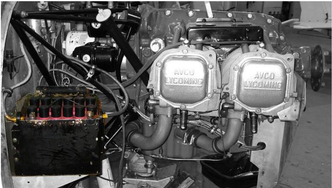
Slika 3. Olovni akumulator ugrađen na zrakoplovu Cessna 152, [5]
