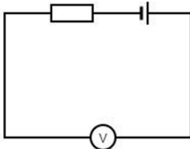
Slika 13. Shema mjerenja napona neopterećenog akumulatora, [8]
