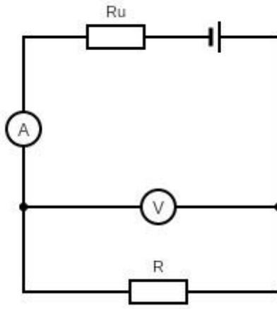
Slika 14. Shema za mjerjenje napona i struje akumulatora pod opterećenjem, [8]
