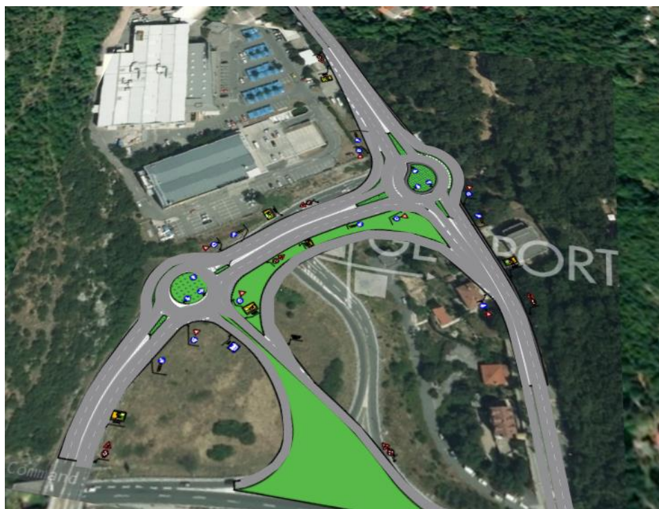
Slika 45. Varijantno rješenje 2 – kružno raskrižje sa spiralnim tokom kružnog prometa
