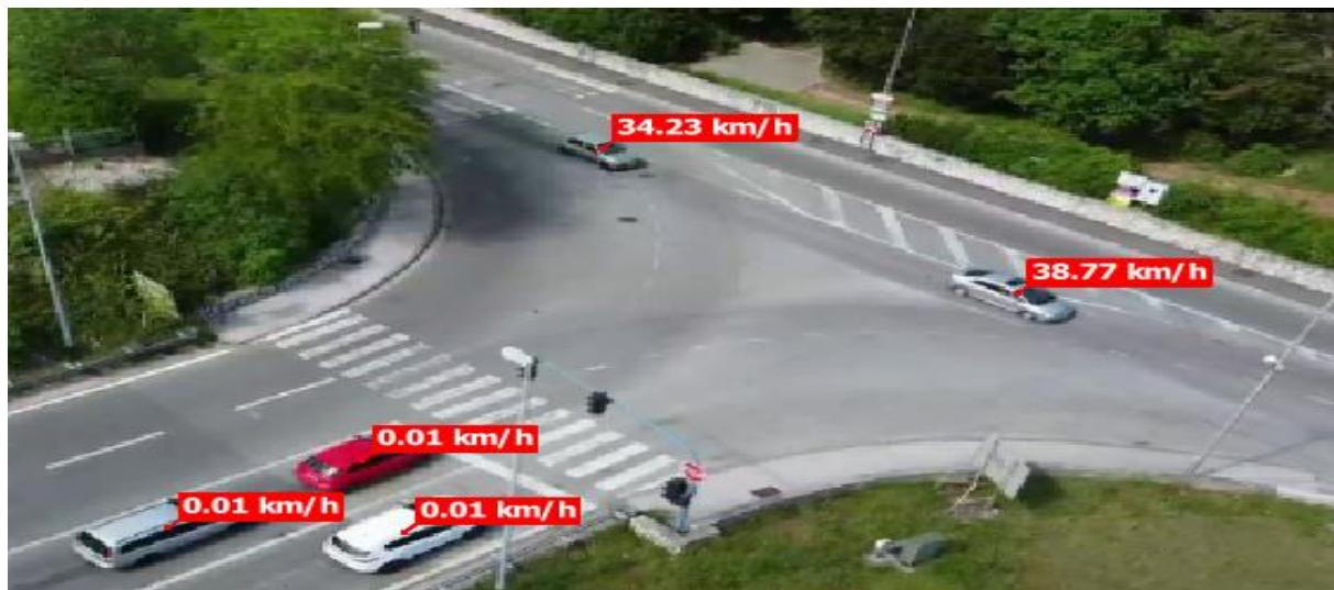
*Slika 33. Prikaz brzina vozila*
