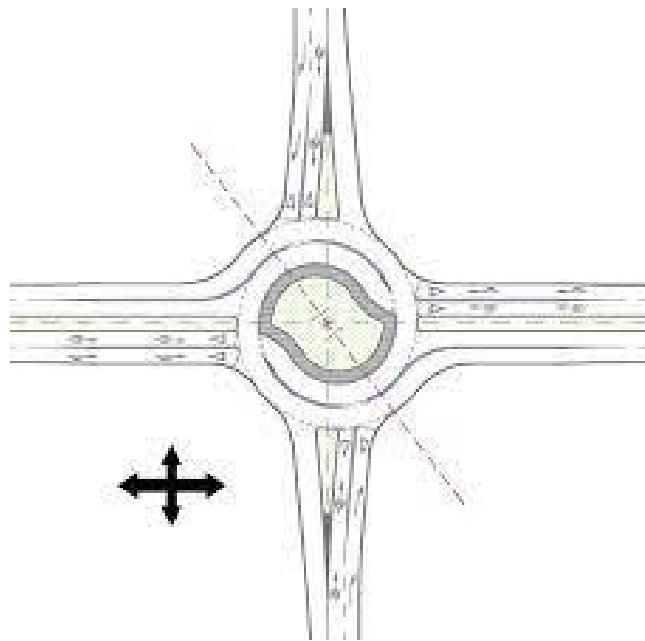
*Slika 38. Primjer četverokrakog turbo kružnog raskrižja, [19]*
