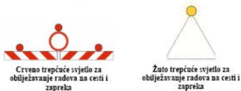
Slika 25: Prometna svjetla za obilježavanje radova i drugih zapreka
