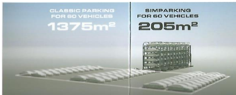
Slika 9. Odnos izvan uličnog i simparking kapaciteta 25
