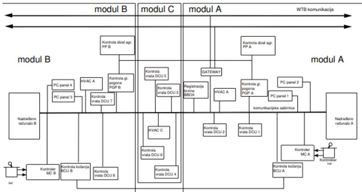
Slika 6: Blok shema sustava upravljanja dizel-motornog vozila
