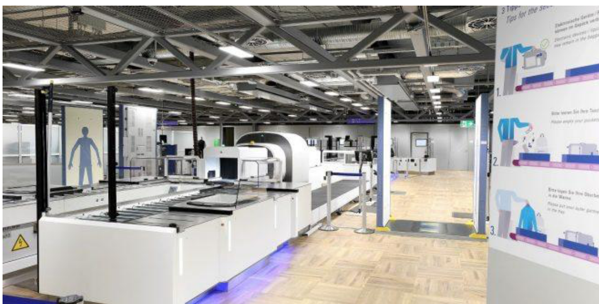
Slika 16. CT skeneri za ručnu prtljagu u Zračnoj luci Frankfurt Izvor: [49]
