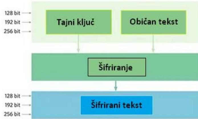
**Slika 6.** Blokovski dijagram prikazuje način rada AES algoritma, [15].
