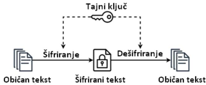
**Slika 2.** Princip rada simetričnog kriptografskog sustava, [13].
