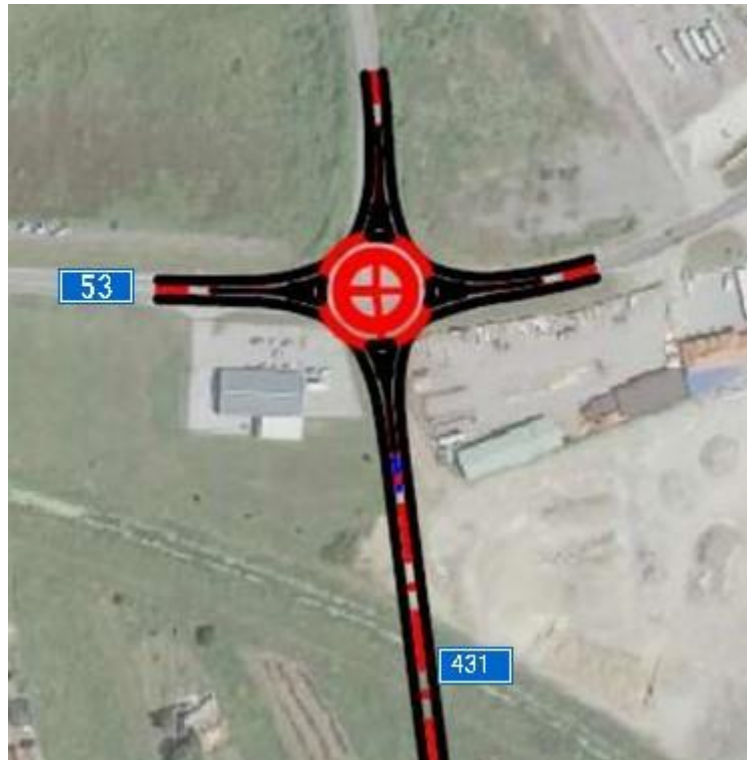
Slika 23. Situacijski prikaz raskrižja s kružnim tokom prometa
