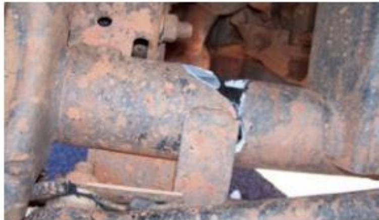
Slika 30. Prikaz puknuća na kućištu vratila
