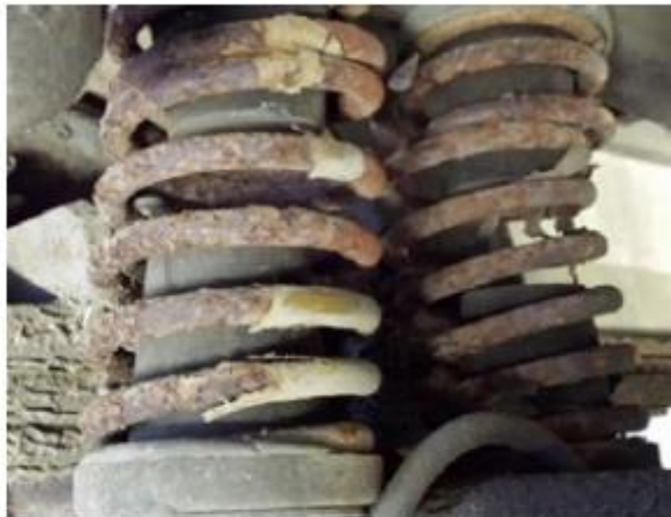
Slika 32. Prikaz korodirane opruge
