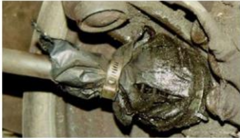
Slika 31. Improvizirano saniranje oštećene manšete
