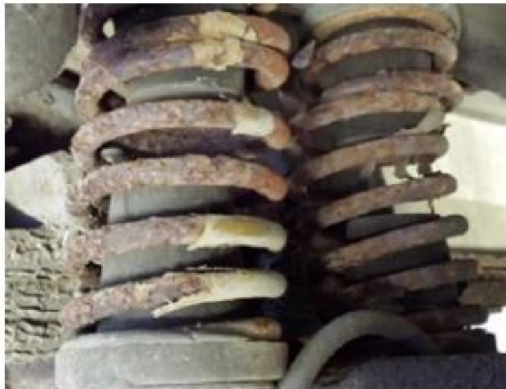
Slika 32. Prikaz korodirane opruge
