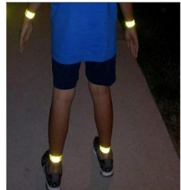
Slika 21. Retroreflektirajući materijali za označavanje ljudi
