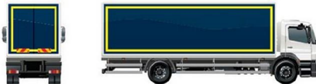
Slika 24. Primjer potpune konture na vozilu
