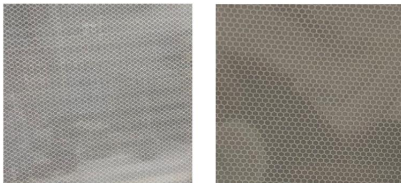
Slika 9. Folije klase IIP (lijevo) i IIS (desno)
