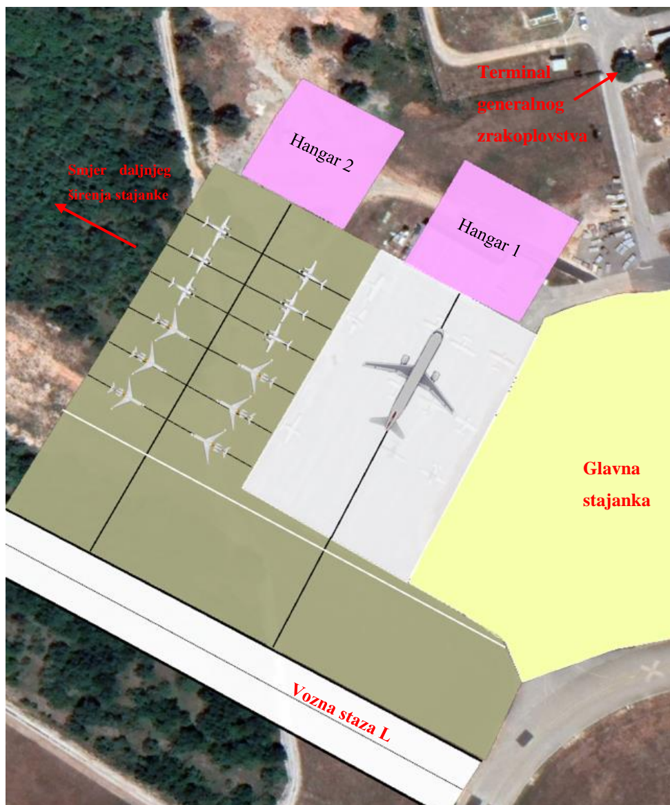
Slika 35. Predložena unaprjeđenja kod stajanke za generalno zrakoplovstvo
