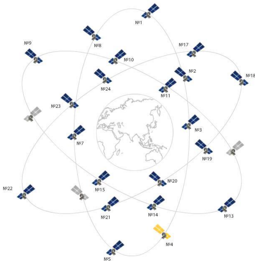
Slika 13. Konstelacija GLONASS satelita, [29]
