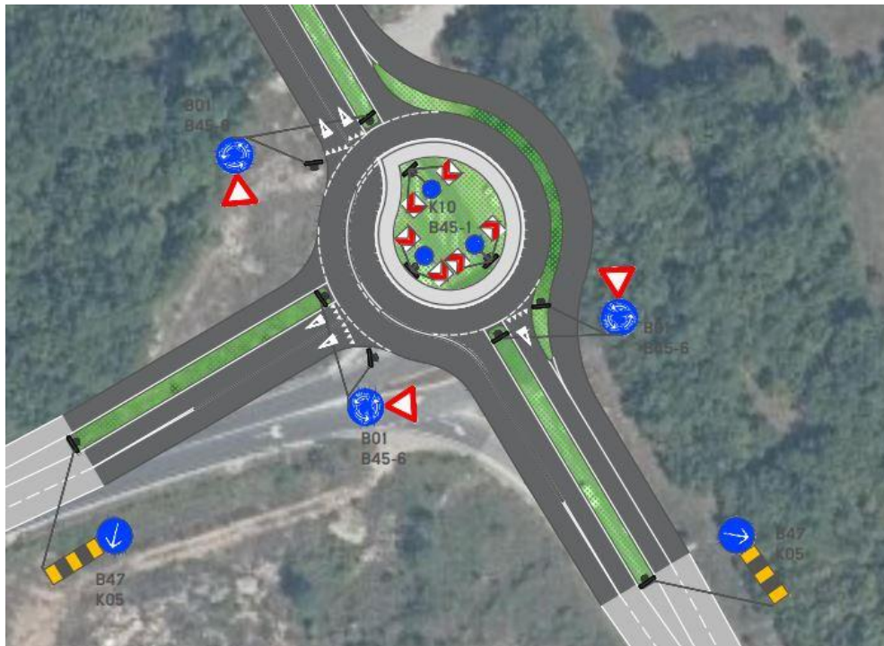
Slika 23. Prijedlog rješenja turbo kružno raskrižje
