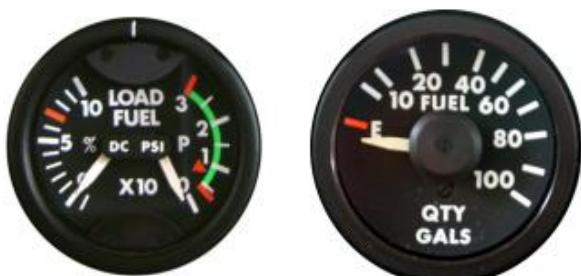
Slika 4. Instrumenti za mjerjenje tlaka i količine goriva [1]
