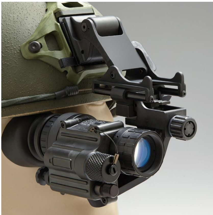
Slika 3. PVS-14 NVG monokular [4]
