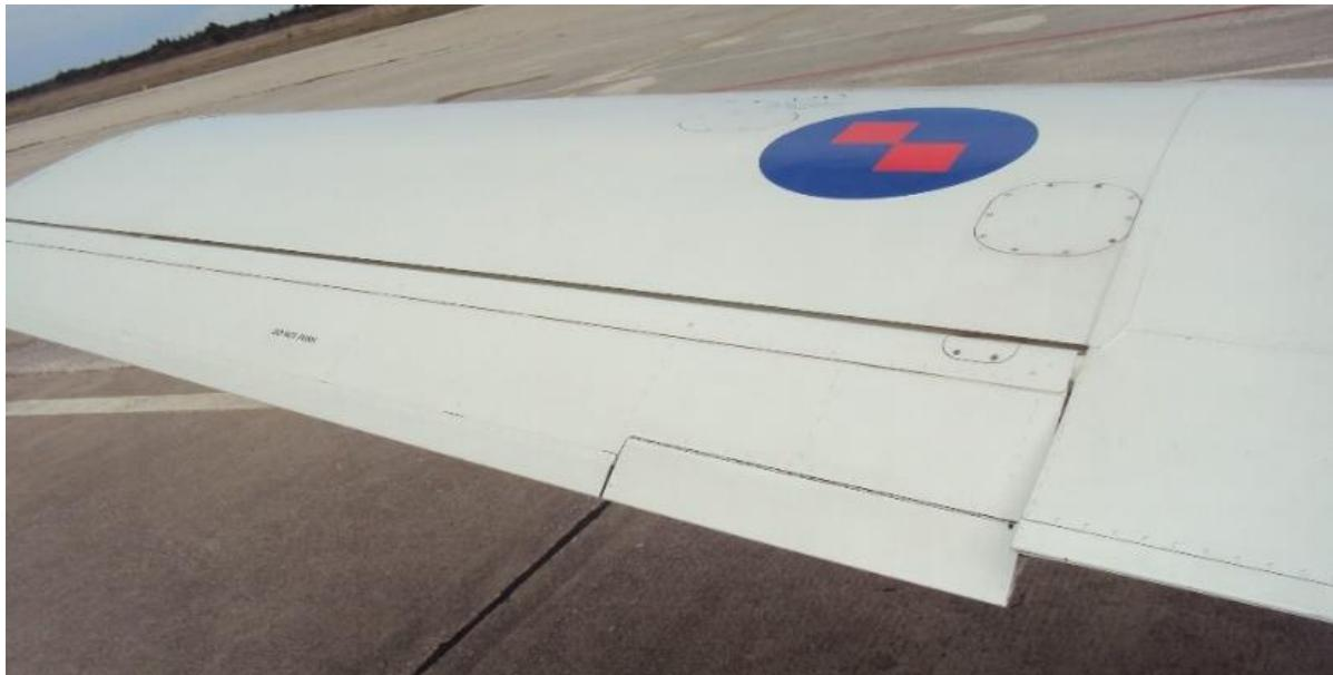
Slika 7. Krilca na zrakoplovu Pilatus PC-9M [2]
