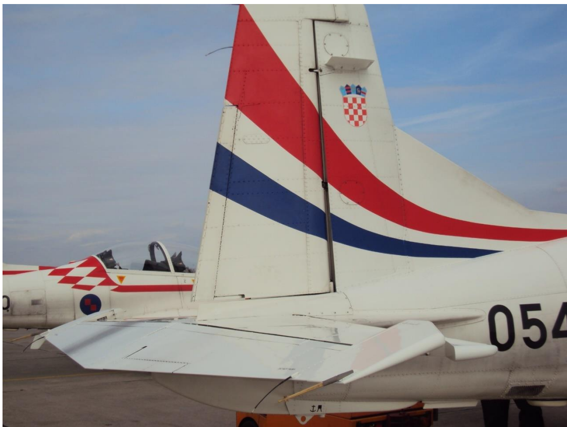
Slika 8. Kormilo visine i kormilo pravca na zrakoplovu PC-9M [2]
