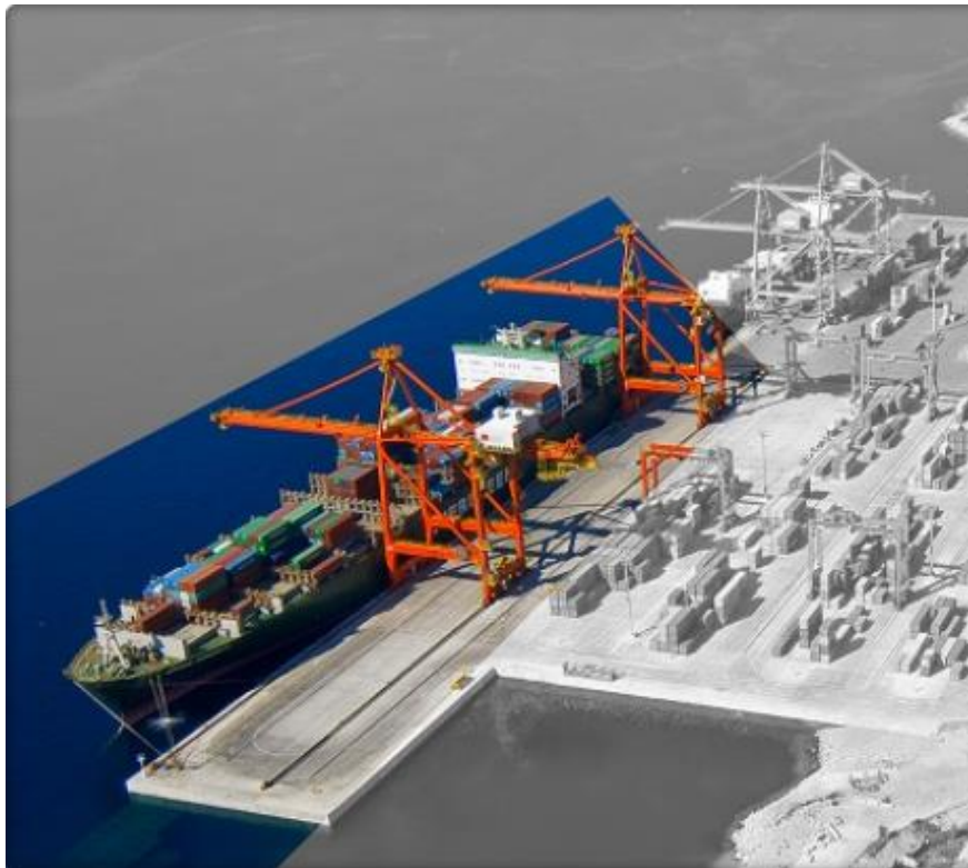
Slika 21: Obalne Post - Panamax i Panamax dizalice u luci Rijeka
