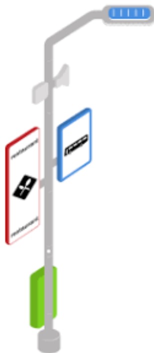
Slika 21. Višenamjenski stup javne rasvjete
