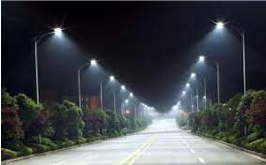
Slika 14. Dvostrani raspored izvora svjetlosti
