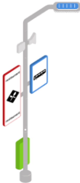
Slika 21. Višenamjenski stup javne rasvjete
