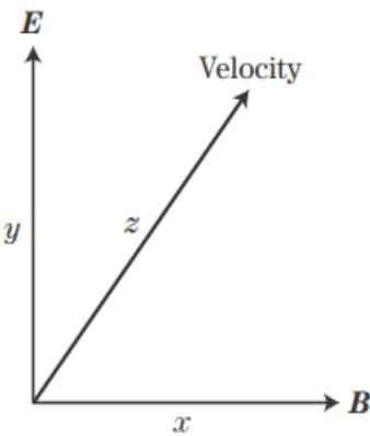
Slika 2 Orientacija elektromagnetski polja i vektor brzine [1]
