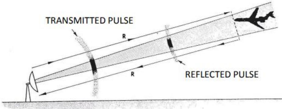
Slika 8 Mjerenje udaljenosti mete(zrakoplova) od radara [9]
