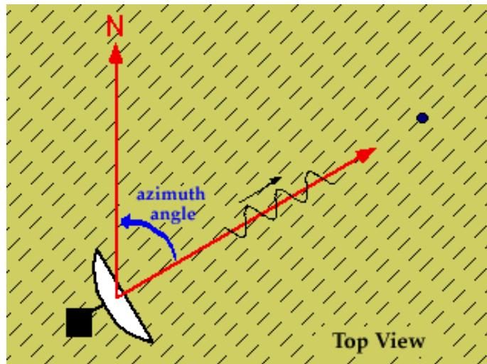
Slika 6 Azimutni kut [5]
