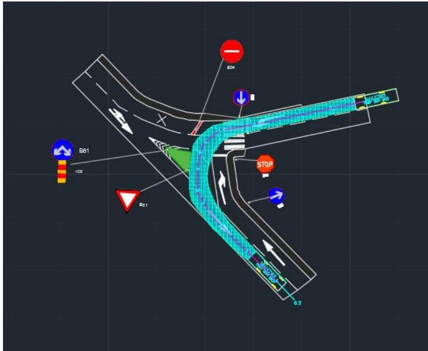
Slika 45. Trajektorija prolaska mjerodavnog vozila
