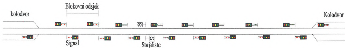
Slika 52: Područje otvorene pruge između dva kolodvora
