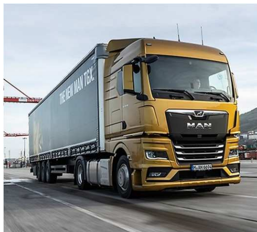
Slika 13. Teretno vozilo kategorije N3 namijenjeno vuči poluprikolice
