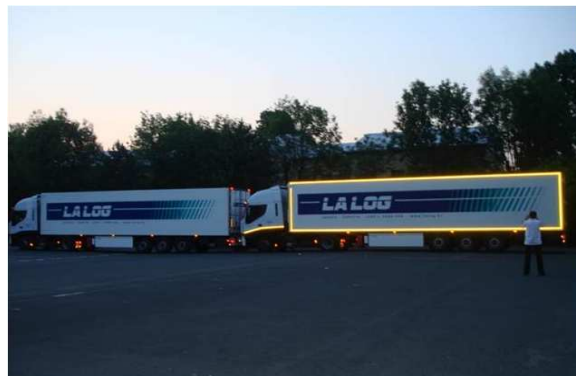
Slika 11. Primjer vidljivosti vozila označenog reflektirajućim trakama i neoznačenog u sumraku
