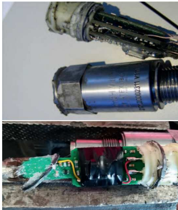
Slika 26. Prikaz senzora tahografa s ugrađenim enkoderom za prekid signala
