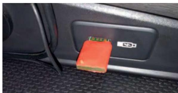
Slika 28. Uredaj za manipulaciju radom tahografa spojen na USB priključak
