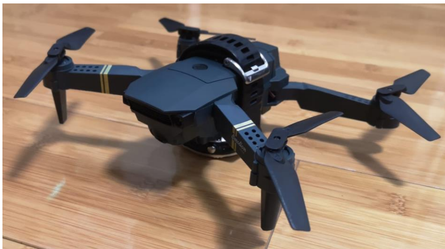
Slika 34 GPS prijemnik pričvršćen za dron
