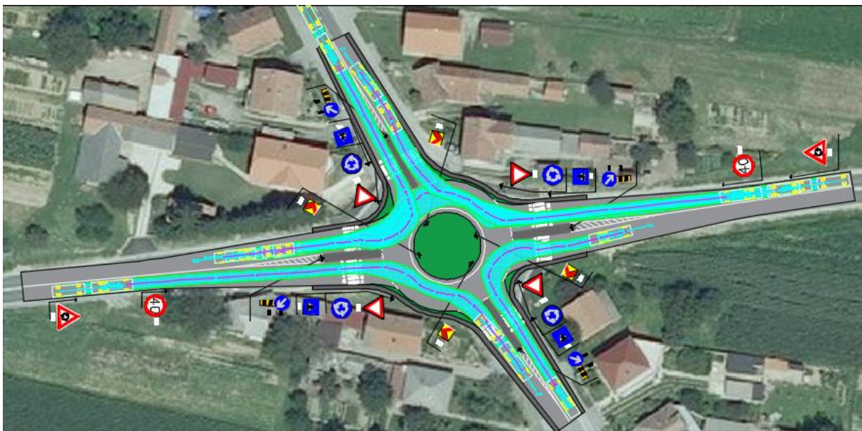
Slika 29. Kružno raskrižje Obilaznica - V. Lisinskog - Glavna s trajektorijama
