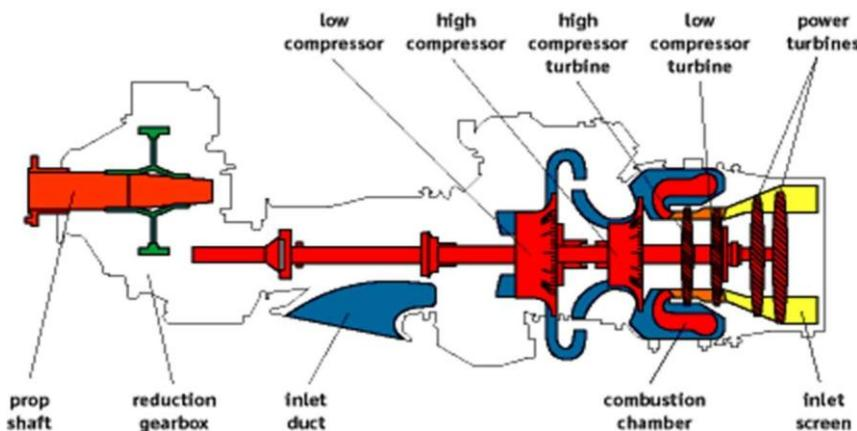
Slika 22. - Shema motora PW100[19]
