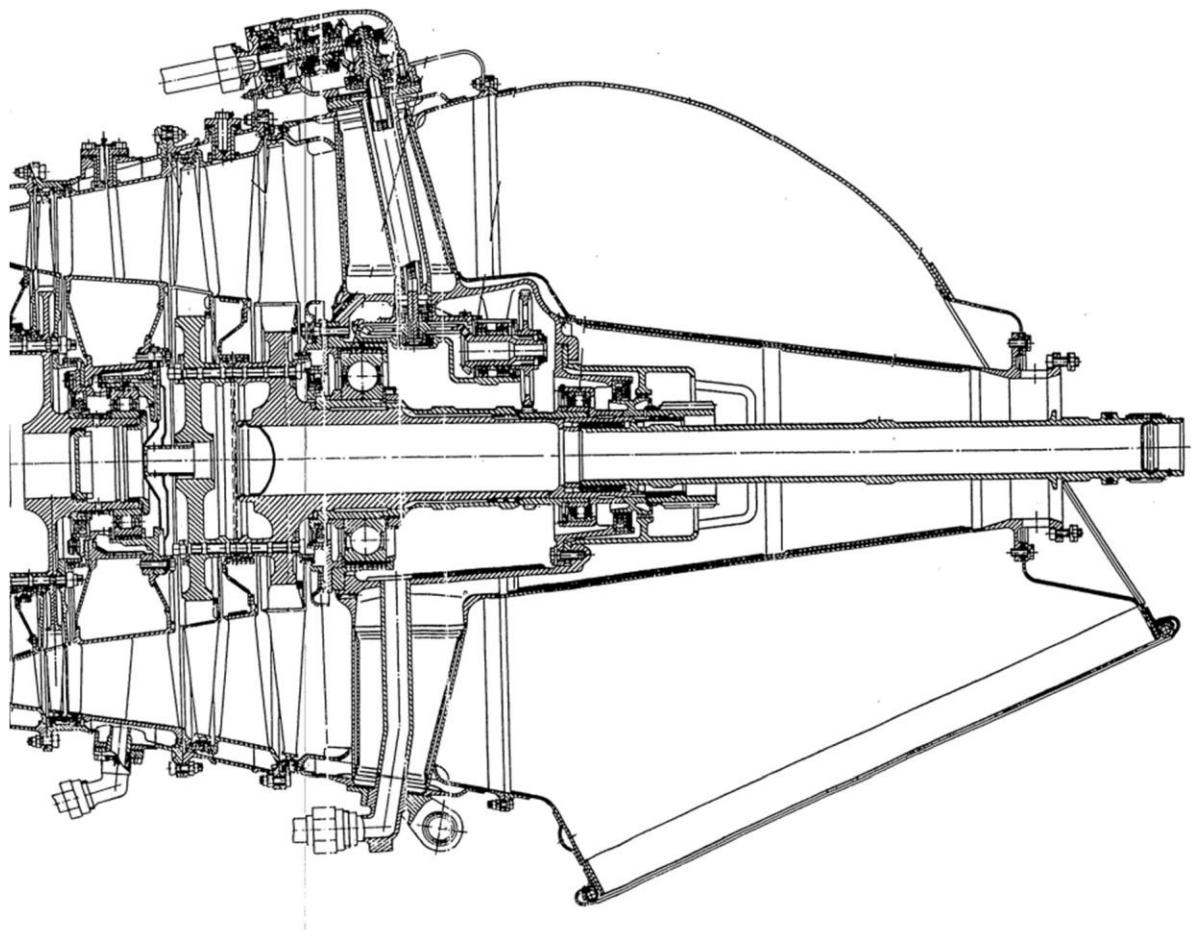
Slika 7. - Prikaz turbine i ispušne grane na motoru[2]
