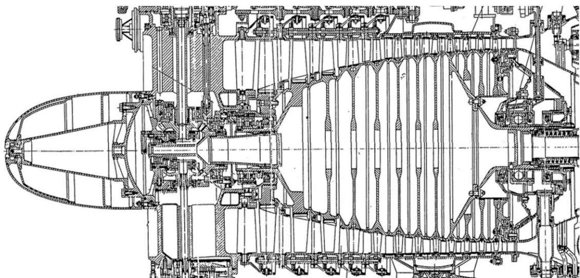
Slika 4.- Shema kompresora motora TV3-117[2]
