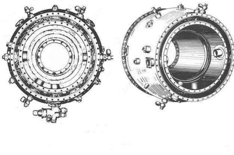
Slika 6. – Komora za izgaranje motora *TV3-117*[2]
