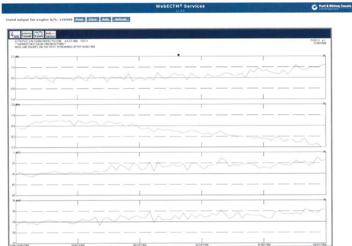
Slika 25.- Prikaz grafra fluktuacije temperature između turbina (ITT) [13]
