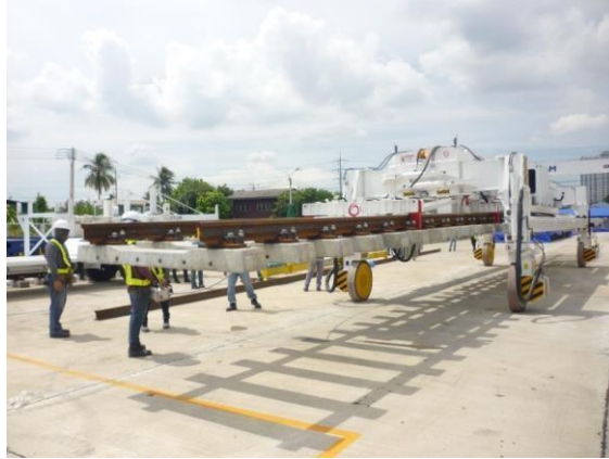
Slika 6. Vozilo za polaganje kolosijeka
