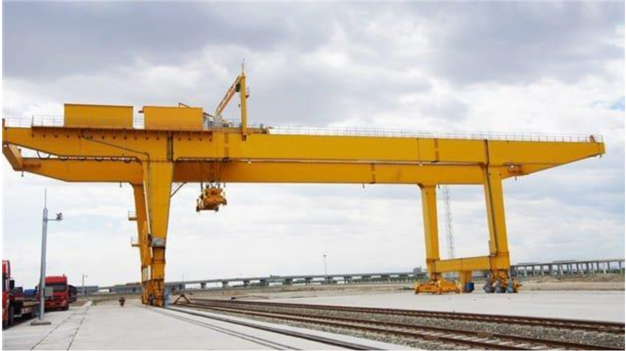
Slika 7. Dizalice koje se koriste za postavljanje kolosječne rešetke za brze vlakove Izvor:
