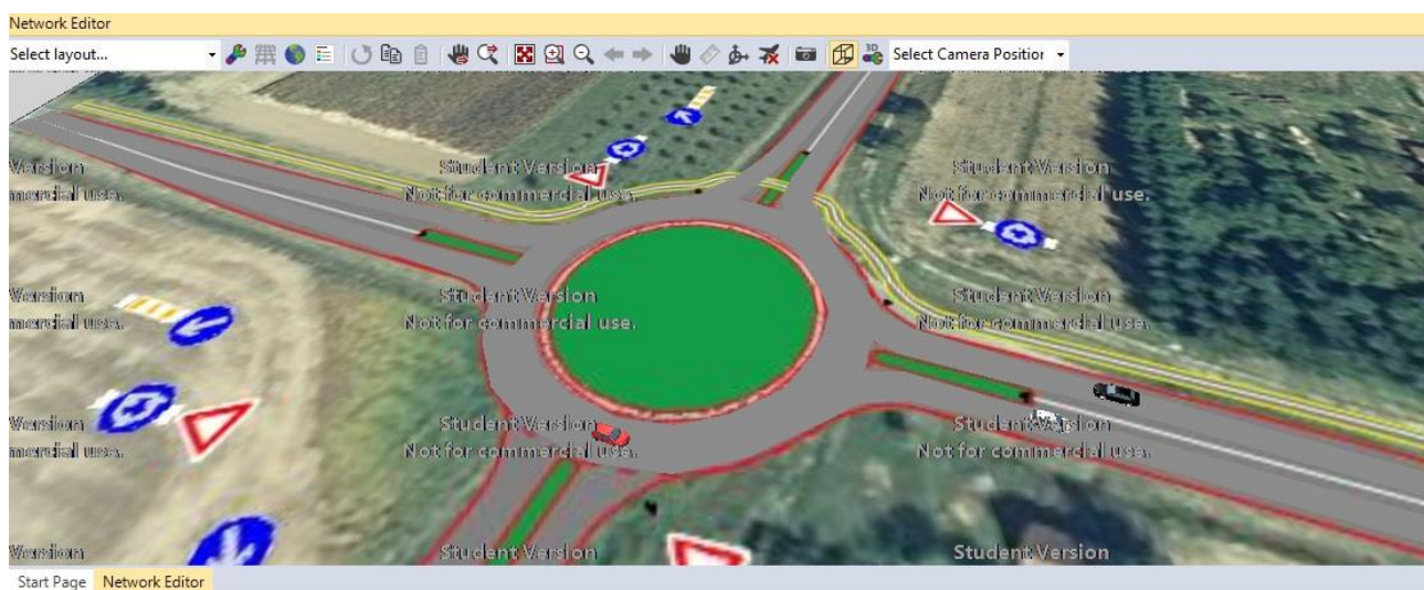
Slika 42.: Prikaz simulacijskog modela prijedloga rješenja raskrižja s kružnim tokom prometa
