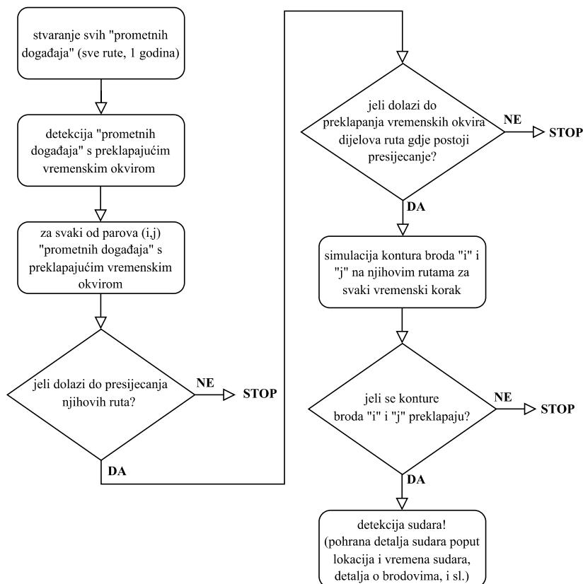
Slika 4: Ilustracija algoritma za detekciju sudara [41, 61]
