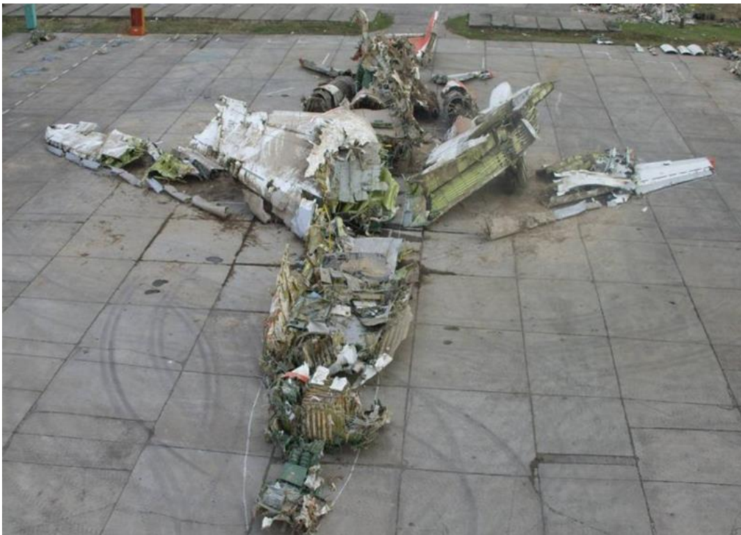
Slika 8. 2D rekonstrukcija zrakoplova
