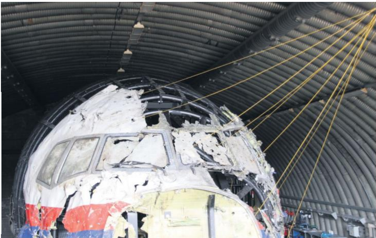
Slika 23. Rekonstrukcija prednjeg dijela zrakoplova i smjer udara visokoenergetskih objekata
