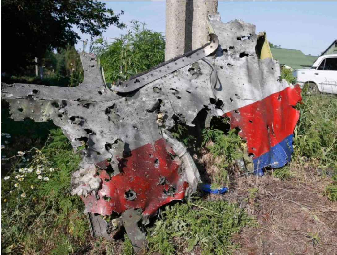
Slika 18. Okvir lijevog prozora pilotske kabine
