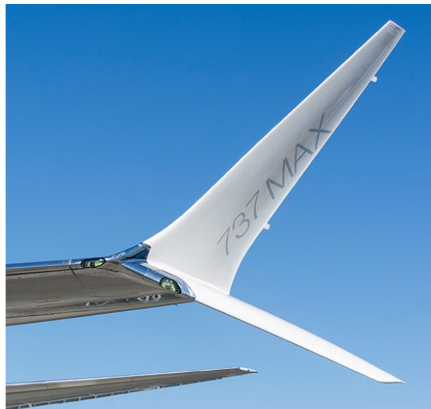
Slika 7. Wingleti zrakoplova 737 MAX
