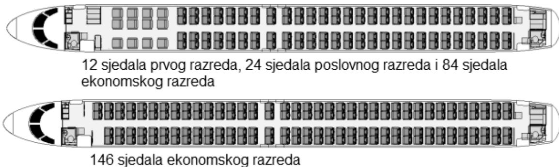
**Slika 13.** Tipične konfiguracije putničkih kabina zrakoplova E 195-E2
