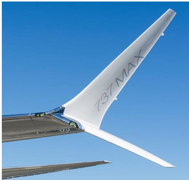
**Slika 7.** Wingleti zrakoplova 737 MAX
