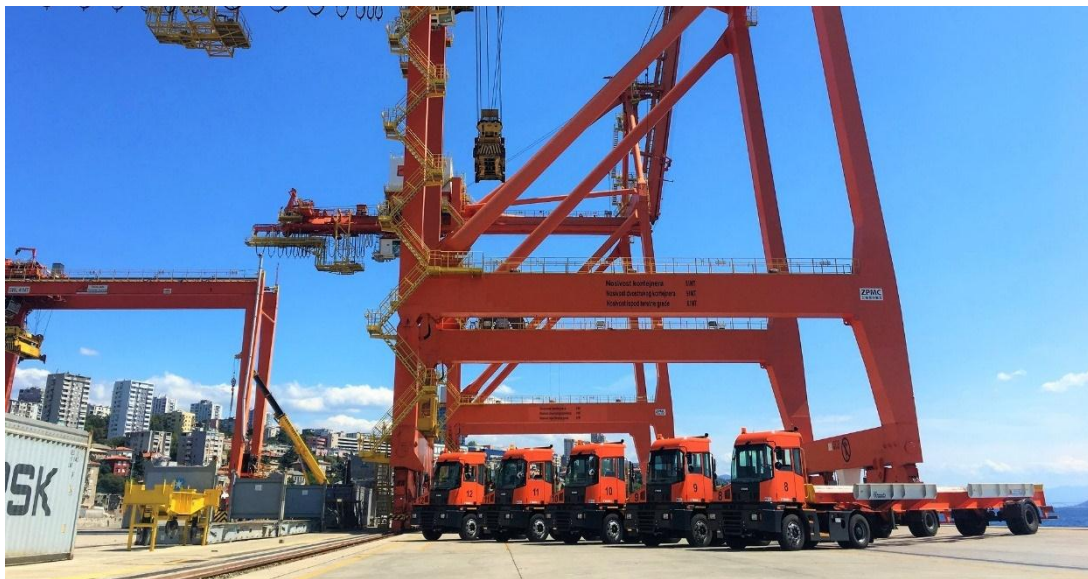
Slika 18. MAFI traktori (tegljači) na terminalu Jadranska vrata
