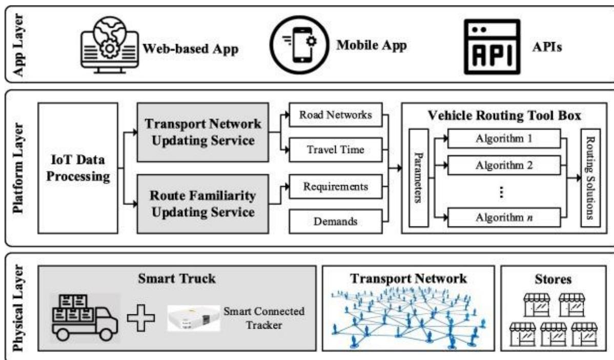
**Slika 31. Prikaz osnovnih slojeva sustava optimizacije prijevoza primjenom IoT-a**
