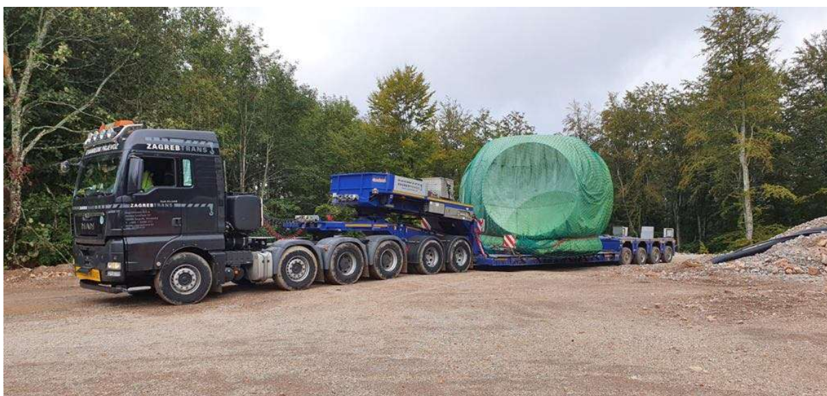
Slika 26. Prikolica natovarena generatorom vjetroelektrane
