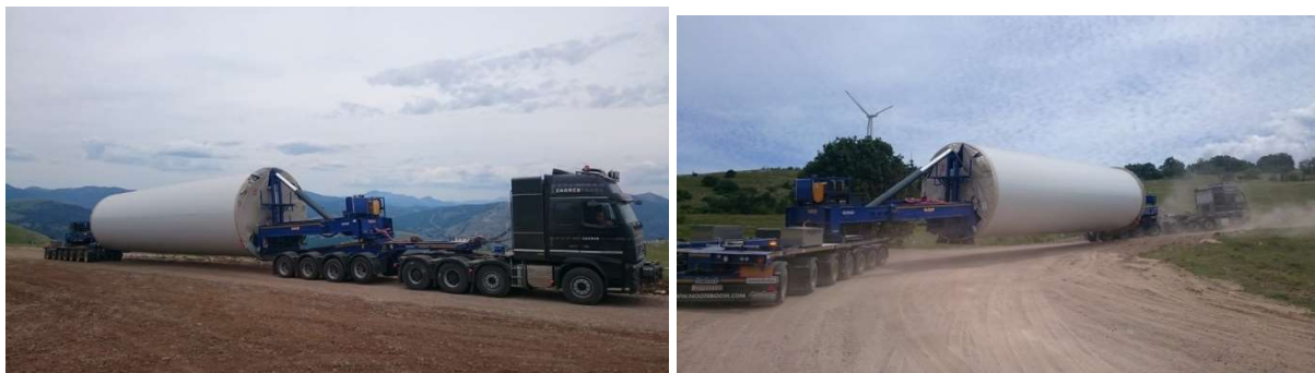
Slika 24. Prijevoz cijevi (tornja) vjetroagregata
