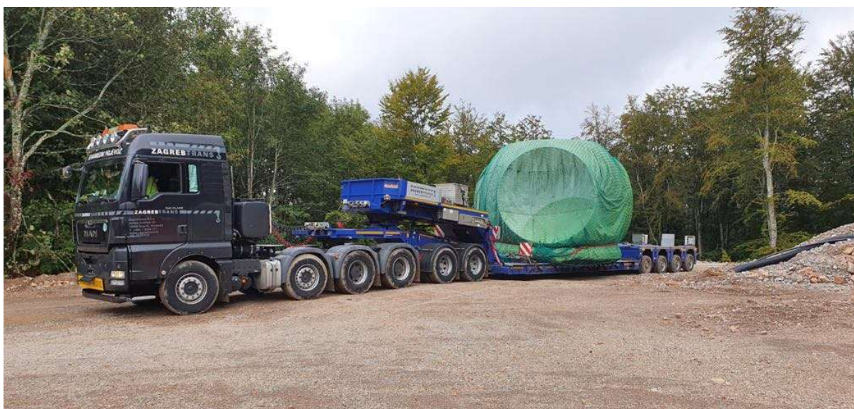
Slika 26. Prikolica natovarena generatorom vjetroelektrane
