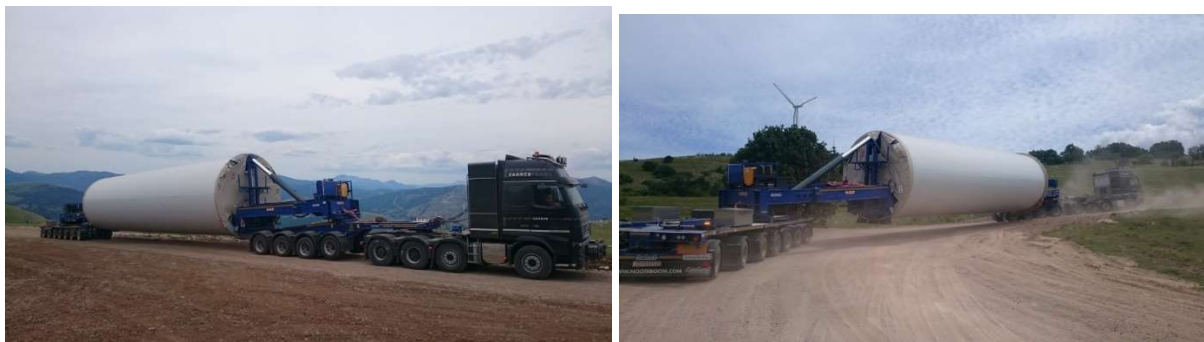
Slika 24. Prijevoz cijevi (tornja) vjetroagregata
