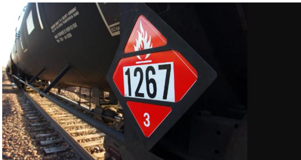
Slika 31: Postavljanje listice opasnosti na vagon
