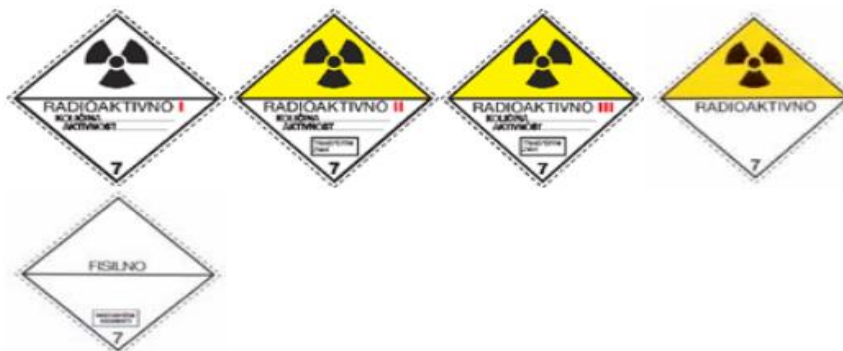
Slika 7: Znakovi opasnosti za različite kategorije radioaktivnih paketa i znak opasnosti za vozilo kojim se prevoze radioaktivni izvori
