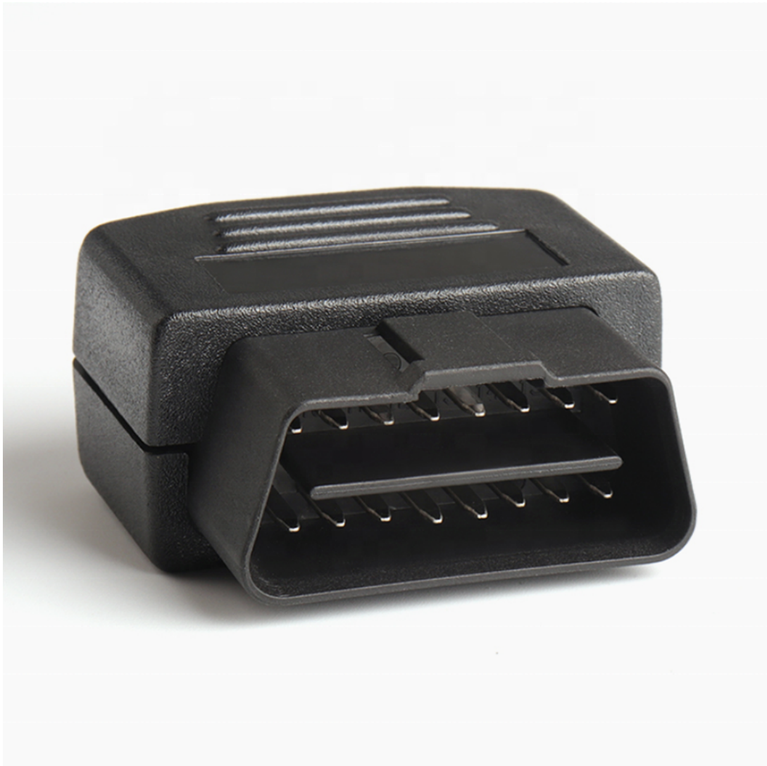
Slika 8: Prikaz OBD-II priključka Izvor: [14]
