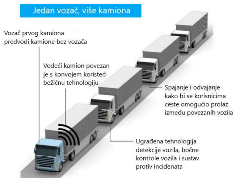
Slika 6. Primjer načina rada sustava postrojavanja kamiona
