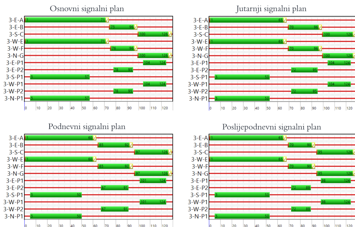
Slika 17: Signalni planovi raskrižja R_3
