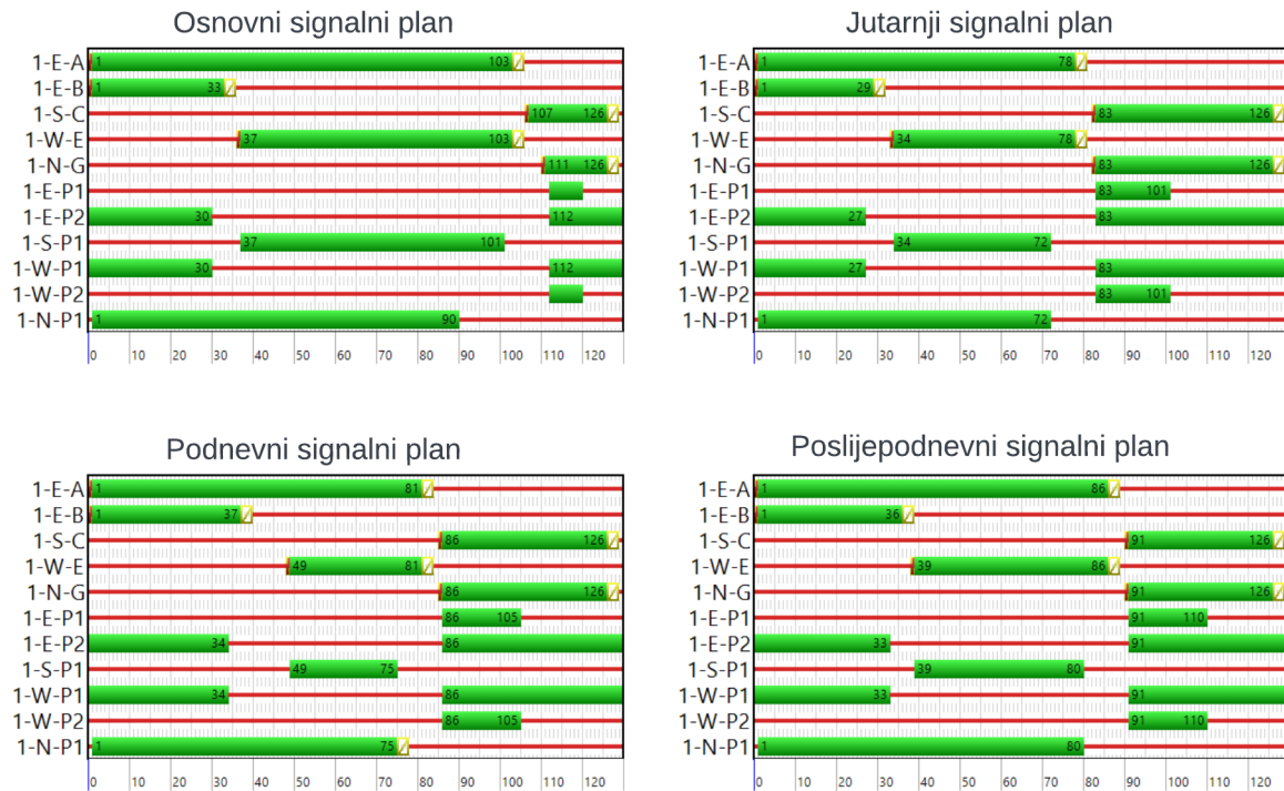
Slika 15: Signalni planovi raskrižja R_1
