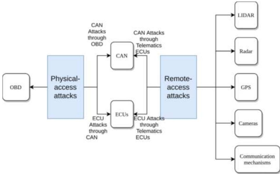
Slika 4.4. Mogući ulazi u povezana vozila napadom na daljinu i fizičkim pristupom vozilu [21]
