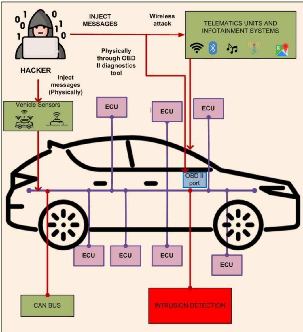
Slika 4.8. Cyber napad izvediv korištenjem OBD ključa [31]
