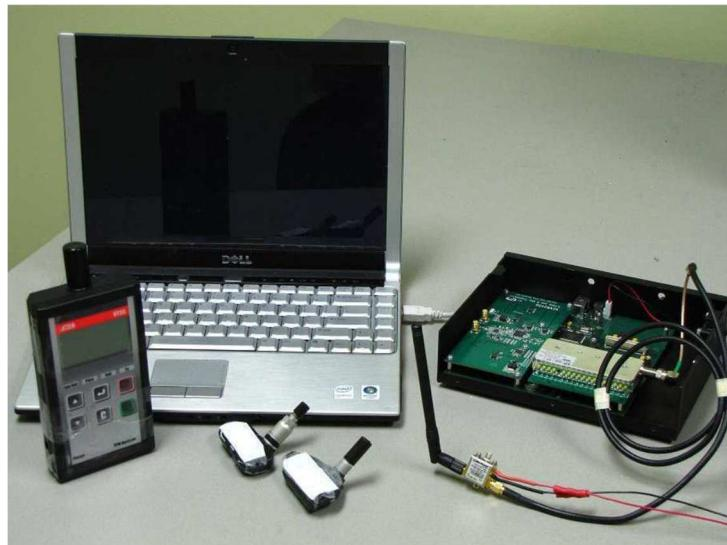
Slika 4.7. Oprema za neovlašteni pristup povezanom vozilu kroz TPMS [28]
