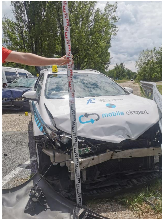
Slika 29. Mjera oštećenja prednjeg dijela vozila pomoću mjerne letve
