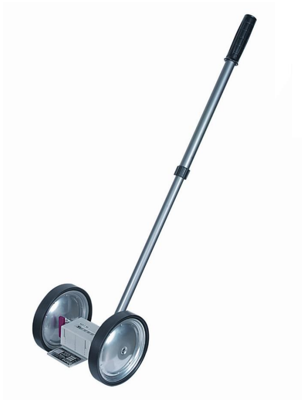
Slika 1. Mjerna kolica za očevid prometnih nesreća Izvor [17]
