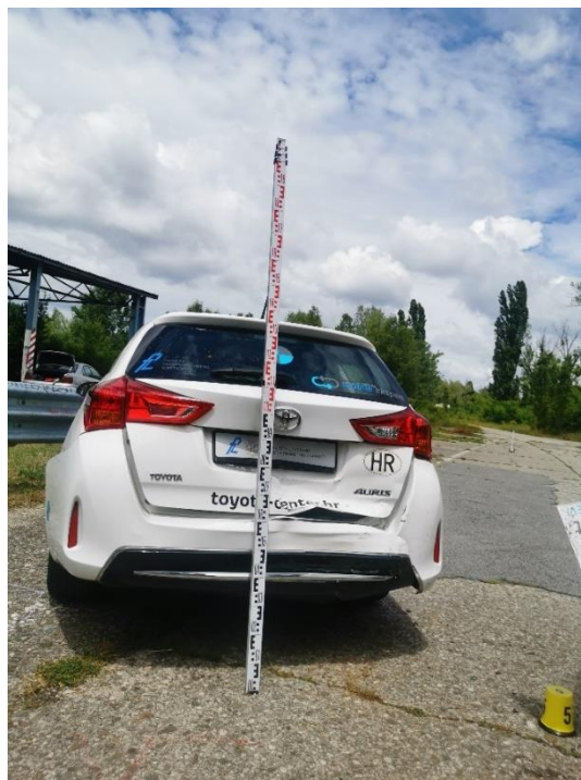
Slika 31. Mjera oštećenja na stražnjoj strani osobnog automobila
