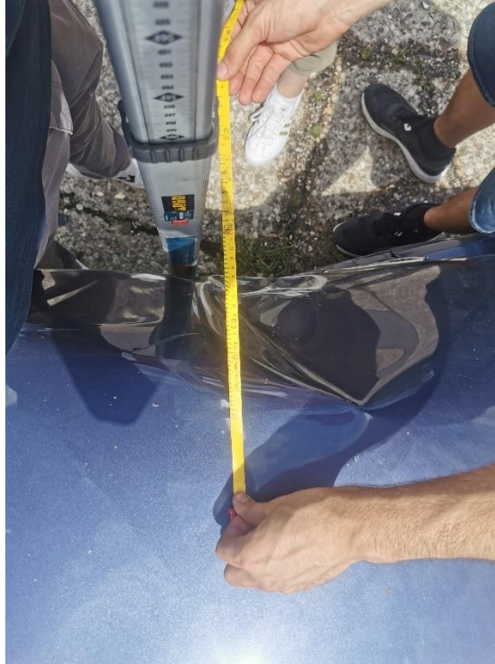
Slika 34. Mjera oštećenja stražnjeg dijela vozila
