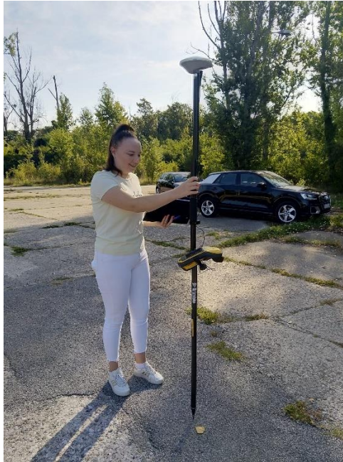
Slika 39. GPS uređaj za pozicioniranje u prostoru montiran na geodetsku šipku - Trimble Geo
