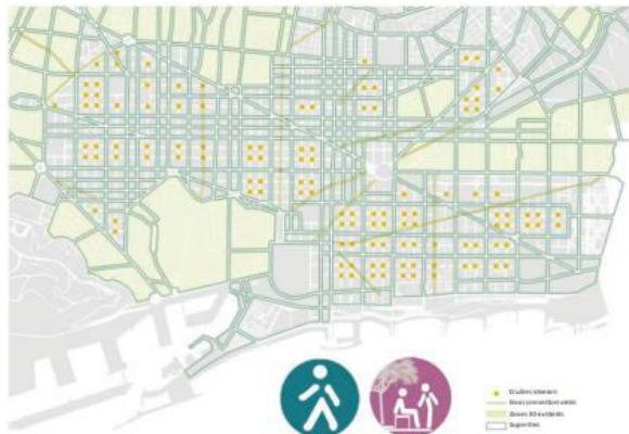
Slika 13 Nova unutarnja raskrižja u četvrti Eixample koja nastaju provedbom superblokova u gradu Barceloni
